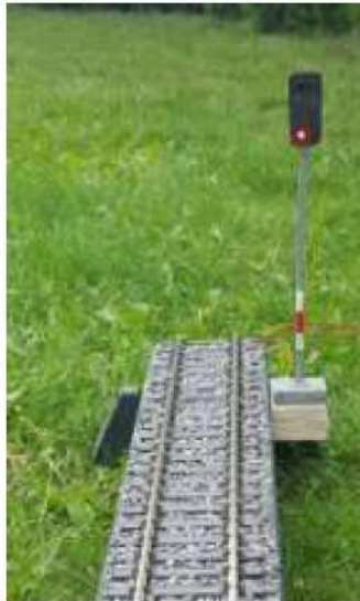
Bild 3.2.1: Signalbegriffe der Licht – Hauptsignale
