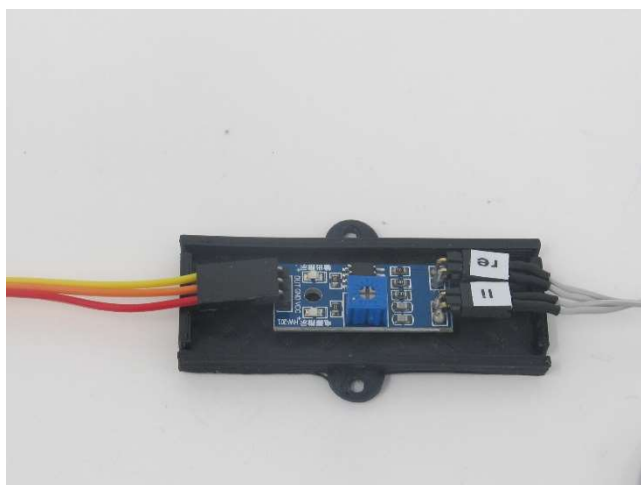
Bild 8.1: Reflex-Lichtschranksmodul mit Gehäuse
