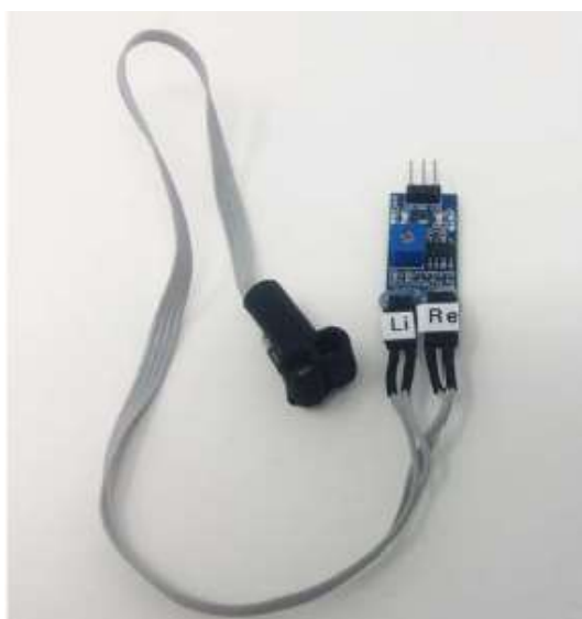
Bild 7.2.3: Lichtschrankenmodul mit angeschlossenem geschlossenem Reflexsensor
