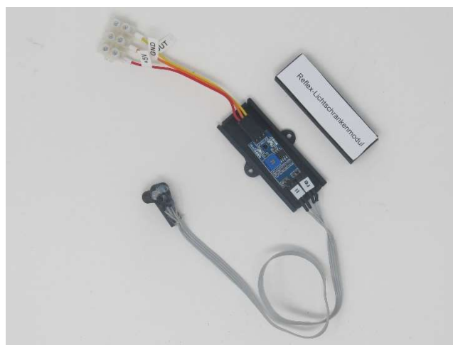
Bild 8.2: Reflex-Lichtschranksmodul mit angeschlossenem Reflexsensor, Adapterkabel_01 und Gehäuse
